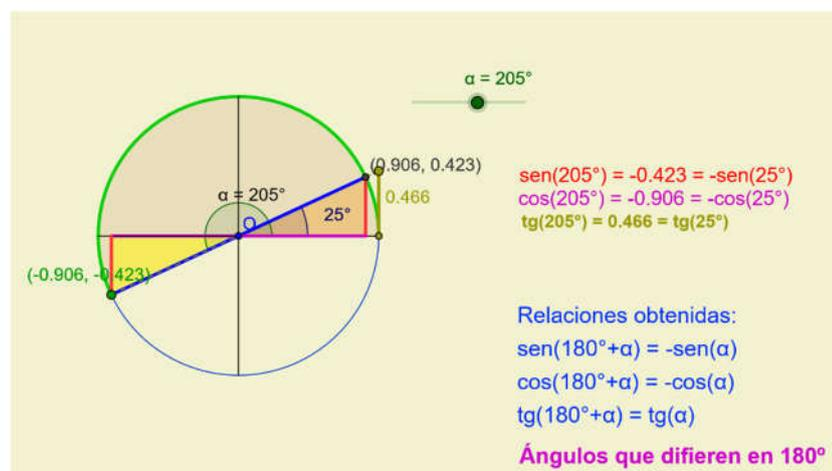
Como podemos observar en la figura, los valores del \u00e1ngulo de  $25^\circ$  y de  $205^\circ$  coinciden en valor absoluto, y solo tenemos que ajustar los signos con la ayuda de un dibujo:
