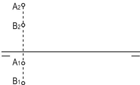
Representar la recta de perfil r que pasa por los puntos A y B. Determinar sus trazas y el ángulo que forma con el P.V
